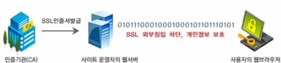
<그림 3-1> SSL 방식의 보안서버 개념도
